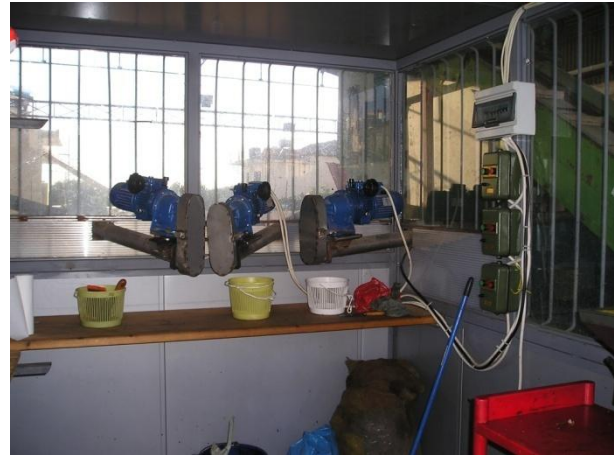
Εικόνα 6 Μηχανικός δειγματολήπτης που οδηγεί αυτόματα το δείγμα στο εργαστήριο μέτρησης ελαιοπεριεκτικότητας
