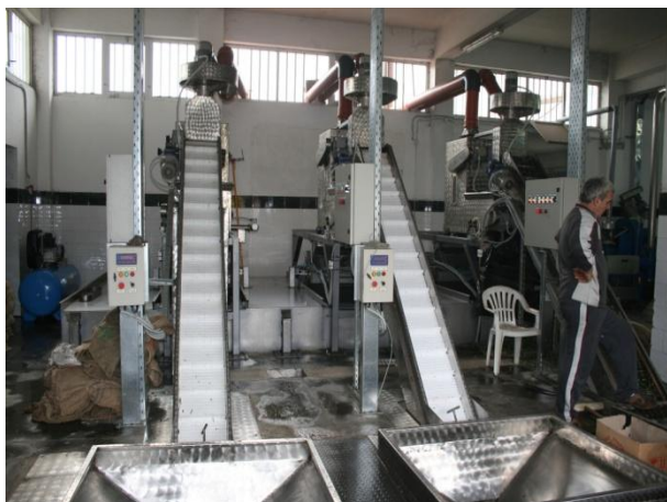
Εικόνα 1 Ιμάντας τροφοδοσίας. Διακρίνεται στο κάτω μέρος η χοάνη παραλαβής
