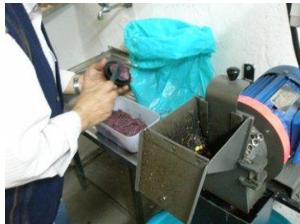
Εικόνα 8 Η ειδική βάση του μηχανήματος μέτρησης ελαιοπεριεκτικότητας γεμίζεται με ελαιοζύμη
