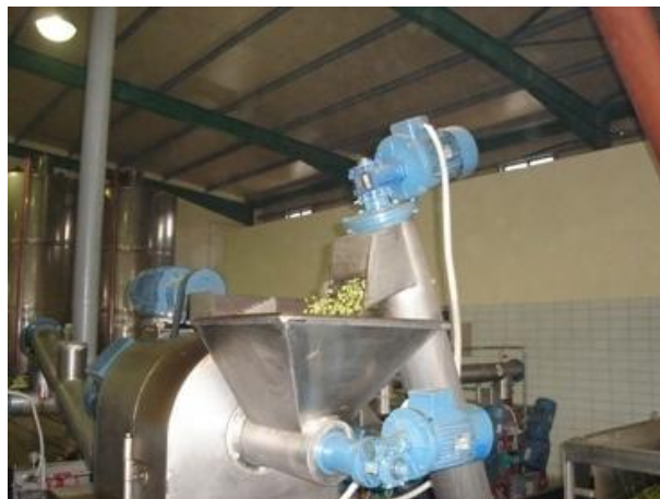
Εικόνα 2 Ο σφυρόμυλος (σπαστήρας) στη γραμμή παραγωγής.
